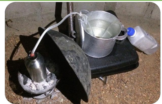
avec les moyens du bord, la vapeur du tuyau est refroidie par passage dans un récipient rempli d'eau froide et on recueille le distillat dans un flacon propre.
